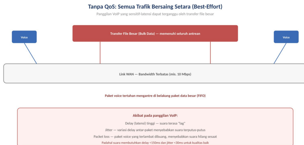
Gambar 11.2. Tanpa QoS, paket voice mengantre setara dengan paket data besar, menyebabkan delay, jitter, dan packet loss
