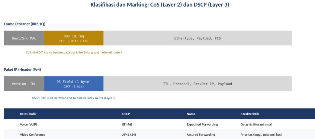
Gambar 11.3. Marking CoS pada field PCP tag 802.1Q (Layer 2) dan DSCP pada header IP (Layer 3)
